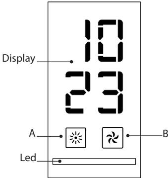
A.Taste Licht ON/OFF: Bei Drücken der Taste schalten sich die Lichter der Abzugshaube ein oder aus.
